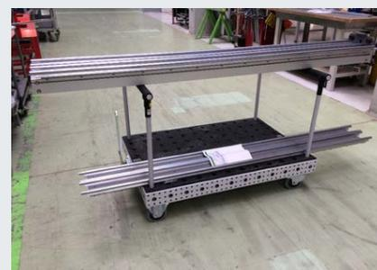
Zwischen den Arbeitsgängen werden insbesondere Bleche hochkant auf Plattformwagen gelagert, wodurch im Pufferlager weniger Platz benötigt wird und die Kommissionierung ohne Stapler sowie höchst ergonomisch erfolgt. Die Transportzeiten konnten erheblich gekürzt werden.
