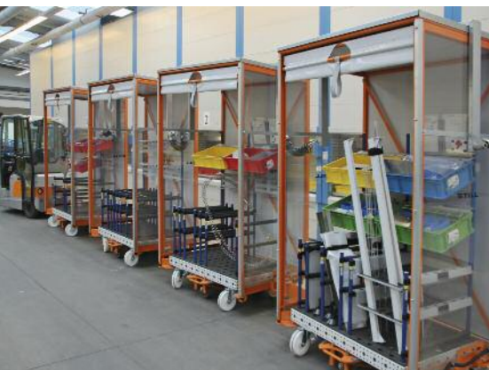
4Dflexiplat mit Tischbügel und 3D-Aufbau. Die Kunststoffkisten werden in die Halter eingehängt.
