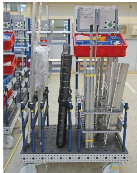
Dank Einlegewannen mit Durchbrüchen können auch lange und schmale Teile aufrecht transportiert werden.
