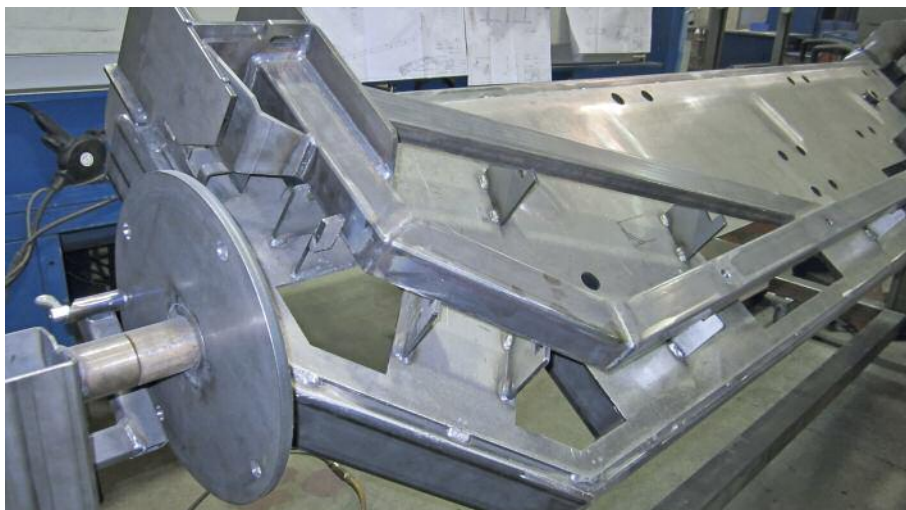
Eine drehbare Schweißvorrichtung für Vorbaugruppen.
